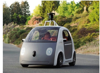
2014年5月，谷歌无人驾驶汽车原型车面世，和一般的汽车不同，该无人车没有方向盘和刹车。
